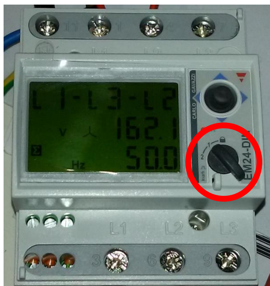
Figura 2 – Posizionare su "1" il cursore rotativo di entrambe i Meter
