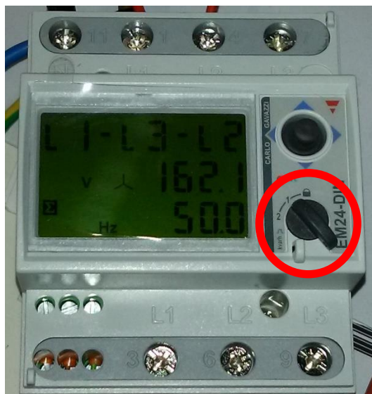
Figura 45 – Settaggio cursore rotativo su meter EM24
